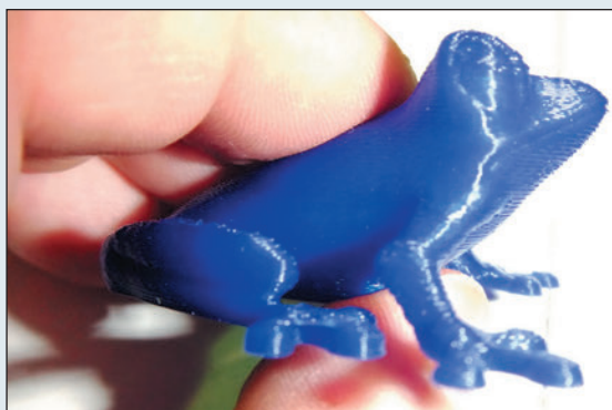
Рис. 3. На макрофотографии распечатанной на 3D-принтере фигурки лягушки хорошо видна полосчатая структура поверхности, полученная за счет послойного нанесения материала (фото автора статьи)
