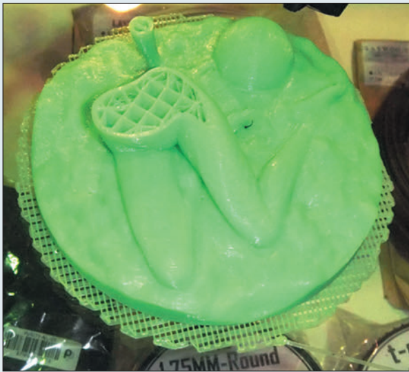
Рис. 5. На этом образце не до конца напечатанной статуэтки на получившемся срезе хорошо видна внутренняя структура изделия с заполнением опорными перегородками для уменьшения расхода материала (фото автора статьи)
